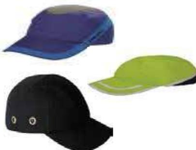
Casquette munie d'une coque en plastique protégeant contre les heurts. Tissu ext: 100% coton coque de protection Coussinets intérieurs En polyéthylènes Anneaux d'aération cuivre
