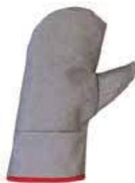
Moufle Alutherm maxi 700°C Réalisée en tissu de verre Alutherm. Isolation interne par une nappe réfractaire de 5 mm + deux écrans aluminisés + drap de laine ignifugé + doublure coton ignifuge Proban. Existe en longueur totale : 30/40/50 cm Taille(s) : 10
