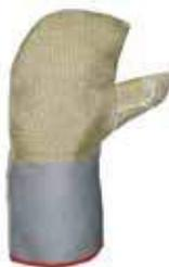
Moufle Pyromica maxi 1000°C Réalisée en tissu de verre Pyromica. Isolation interne par une nappe réfractaire de 5 mm + deux écrans aluminisés + drap de laine ignifugé + doublure coton ignifuge Proban. Existe en longueur totale : 30/40/50 cm Taille(s) : 10
